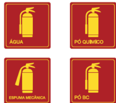
Figura 6 Exemplo de sinalização de combate ao incêndio
